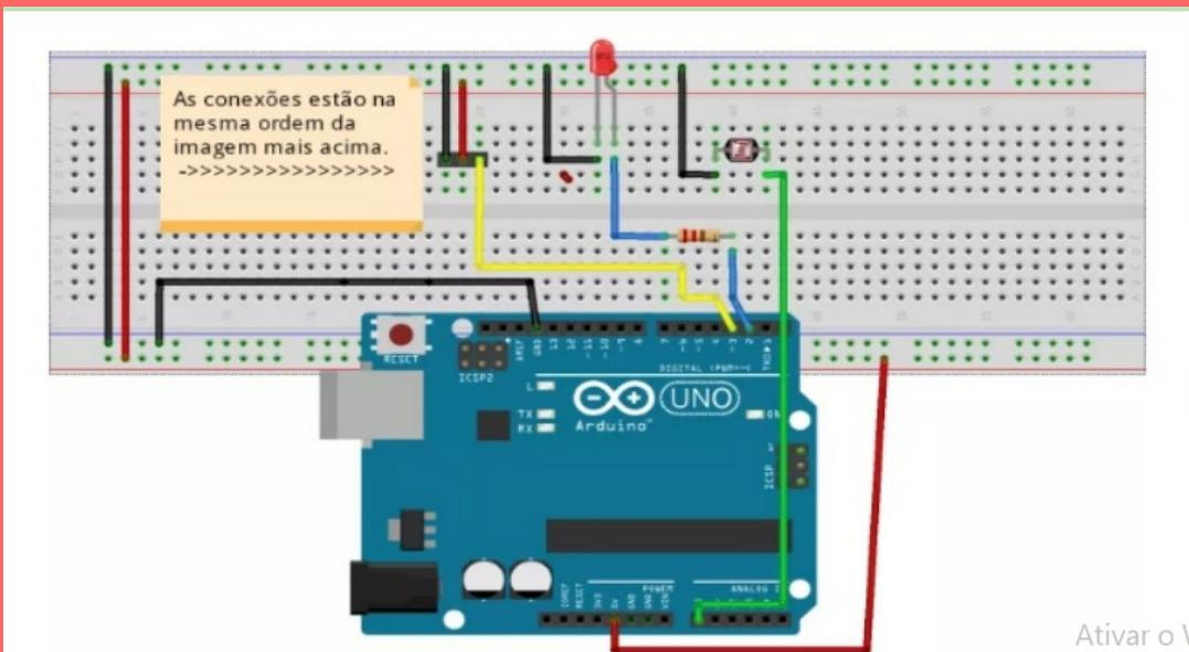
Observe como a LED e o fotoresistor devem ser conectados.
