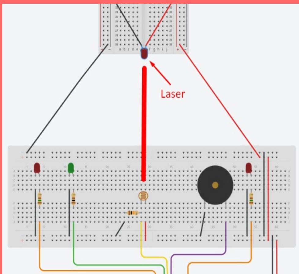
Direcione o laser no sensor LDR. Para calibrar o sensor LDR desenvolva a codificação abaixo.
